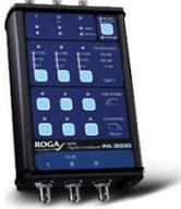
PA-3000 は、3ch のアンプ内蔵型圧電型センサ (IEPE) 用アンプです。IEPE センサ供給電源は 4mA/24V。内蔵電池で動作するポータブルなアンプながら、ローレベル信号出力にも対応した 3 レンジのゲイン切り替え・ハイパスフィルタ On/Off・ローパスフィルタ On/Off をチャンネルごとに、本体操作 SW にて選択することができる機能を備えています。さらにセンサ状態やオーバーロード状態は LED で検出でき、確実な計測が可能です。本体は、アルミニウム筐体、メンブレン SW ですので、粉塵の多い環境での使用にも安心です。
