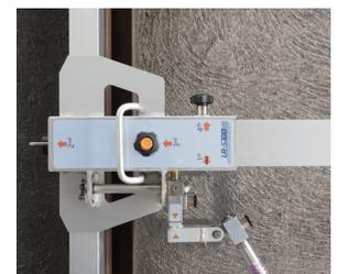
組立は、検測梁に軌間梁を差し込んでダイヤル固定するだけ
