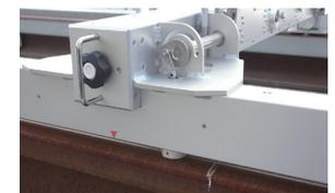
押し棒を下げるとブレーキパッドがレールと接触
