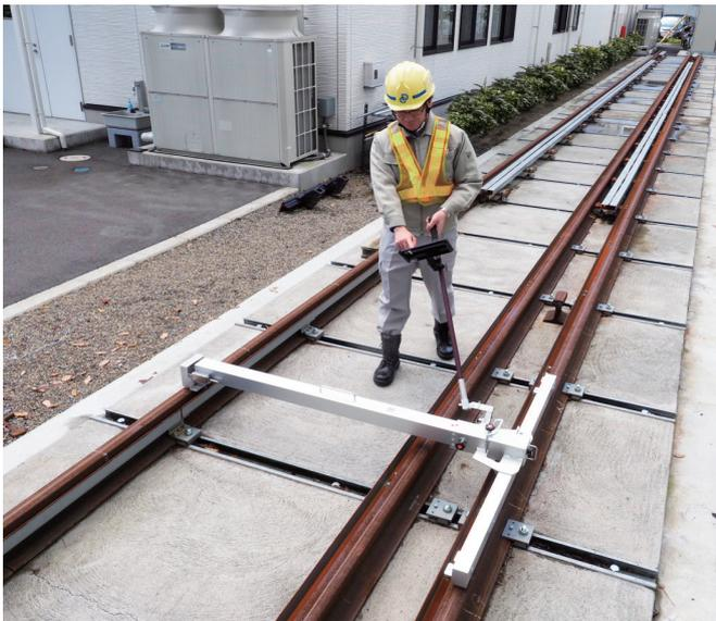
LR-S100は、1.25mの検測梁に設置したジャイロセンサが検知する軌道形状成分を用いて2.5m弦を演算する新しい軌道検測法\*を採用しています。これにより、装置の小型・軽量化と高精度化を実現しました。
