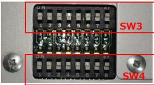
信号入力コネクタ部を手前方向としてカバーを外すと左図のように、上下 2 つのディップスイッチが見えます。
